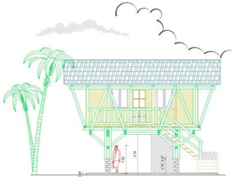
ELEVACION FRONTAL - CASAS ELEVADAS DE BAMBU
